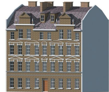
Ryc. 2. Wektoryzacja chmury punktów z nałożeniem tekstury – model 3D (źródło: Biuro Rozwoju Gdańska)
